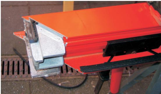
Das stark beschädigte und durch den Notverschluss zerstörte Türprofil kann man nicht mehr instandsetzen. Dieses wird erneuert. Die anderen Beschädigungen können durch Richten und Ausformen in ihre Ursprungsform gebracht werden. Kleinere Unebenheiten werden mit einer 2-Komponenten-Aluminiumersatzmasse ausgeglichen und verschliffen.
